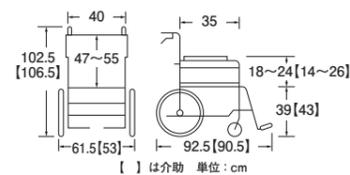
( )は介助 ●前輪:5(6)インチ ●後輪:18(12)インチ ●耐荷重:75kg ●質量:23.5(22.7)kg ●ティルト角度:0°~25°(骨盤のみ)
