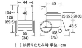
●前輪:6インチ ●後輪:14インチ ●耐荷重:100kg ●質量:20.9kg ●ティルト角度:0°~20°
