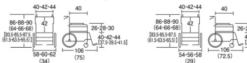
●前輪:6インチ(標準)/5インチ(低床) ●後輪:22インチ(標準)/20インチ(低床) ●耐荷重:100kg ●質量:14.2kg(標準)/15.2kg(低床)
