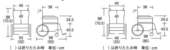
●前輪:6インチ ●後輪:22インチ ●耐荷重:100kg ●質量:9.9kg
