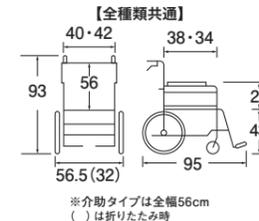
●自走・標準:前輪:5インチ ●後輪:22インチ ●耐荷重:100kg ●質量:13.8kg
