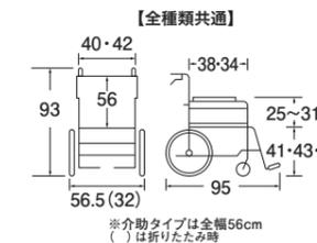
●自走:前輪:5インチ ●後輪:22インチ ●耐荷重:100kg ●質量:17.1kg
