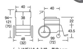
●前輪:6インチ ●後輪:14インチ ●耐荷重:100kg ●質量:19kg ●ティルト角度:0°~30°
