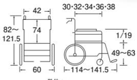
●前輪:6インチ ●後輪:16インチ ●耐荷重:100kg ●質量:24kg ●リクライニング:100°~170°
