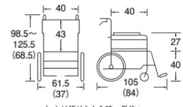
●前輪:4インチ ●後輪:22インチ ●耐荷重:100kg ●質量:24.2kg ●ティルト角度:0°~15° ●リクライニング:100°~117°
