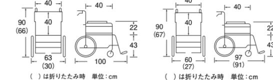
●前輪:6インチ ●後輪:22インチ ●耐荷重:100kg ●質量:13.3kg
