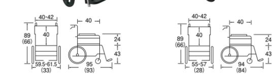
●前輪:6インチ ●後輪:22インチ ●耐荷重:100kg ●質量:9.6kg
