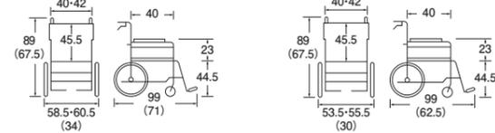
●前輪:6インチ ●後輪:22インチ ●耐荷重:100kg ●質量:14.2kg
