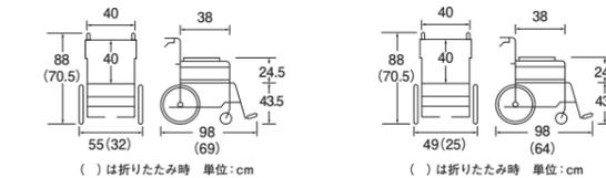
●前輪:6インチ ●後輪:22インチ ●耐荷重:100kg ●質量:11.2kg
