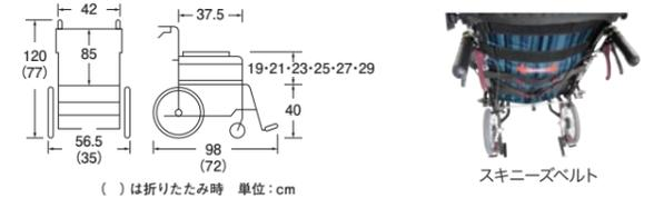
●前輪:6インチ ●後輪:12インチ ●耐荷重:100kg ●質量:21.5kg
