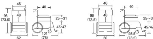
●前輪:6インチ ●後輪:24インチ ●耐荷重:130kg ●質量:16.6kg ●クッション厚さ:前4cm / 後2cm
