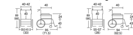
●前輪:6インチ ●後輪:22インチ ●耐荷重:100kg ●質量:10.9kg
