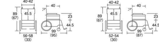
●前輪:6インチ ●後輪:22インチ ●耐荷重:100kg ●質量:12.2kg
