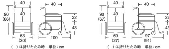
●前輪:6インチ ●後輪:22インチ ●耐荷重:100kg ●質量:12.7kg
